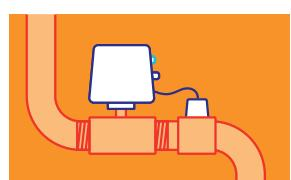
Si vous avez un système qui détecte le flux de l'eau et se ferme automatiquement, mettez-le en mode « away » avant de partir.
