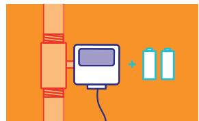
Si vous avez un détecteur de fuite d'eau avec capteur, remplacez les batteries du capteur.
